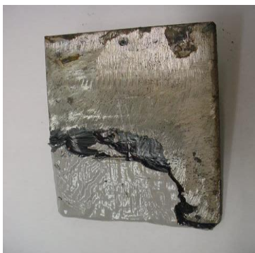
Aspecto da estrutura após 3000 horas de exposição à nevoa salina e remoção do revestimento.
