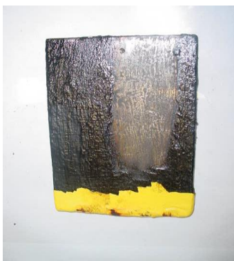
Aspecto da estrutura após 3000 horas de exposição à nevoa salina e remoção do revestimento.
