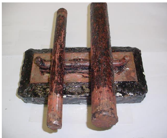
Aspecto da estrutura após 3000 horas de exposição à nevoa salina e remoção do revestimento
